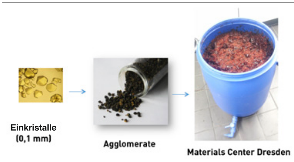
Abb. 6 Aufskalierung von MOF-Produkten in Dresden bis in den 10 kg-Maßstab
