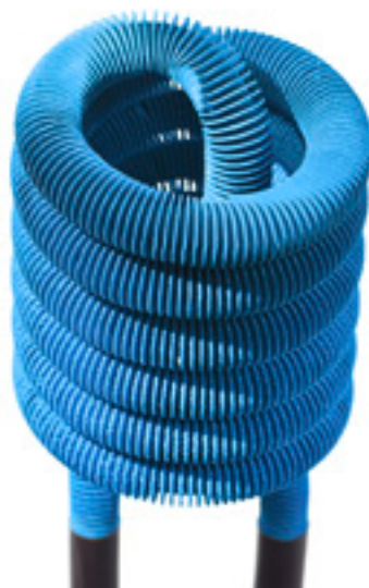
Abb. 4 Mit MOF beschichteter Wärmetauscher Bild: DECHEMA Roadmap MOF
