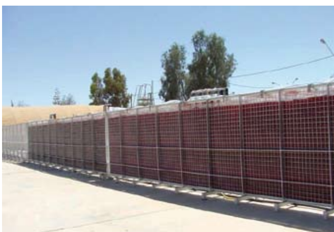
Abb. 4 Green Wall Panel - Beispiel für einen outdoor Plattenreaktor zur Kultivierung von Mikroalgen [8].
