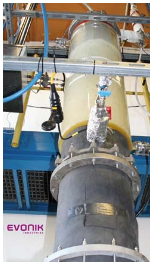
Abb. 2 Maßstabsvergrößerung des entwickelten Blasensäulenreaktors in den Pilotmaßstab (120 L).
