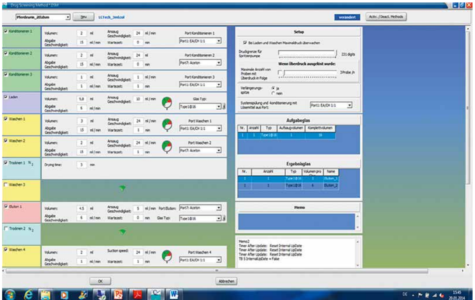
Abb. 1 Die Software des Freestyle wurde auf Anforderung des Kunden so modifiziert, dass der Rückdruck der SPE-Säule konsequent kontrolliert wird. Bei Überschreitung eines in der Methode definierten Drucks wird die Bearbeitung der Probe abgebrochen, diese Probe in der Probenliste markiert, das System gespült und die nächste Probe bearbeitet.
