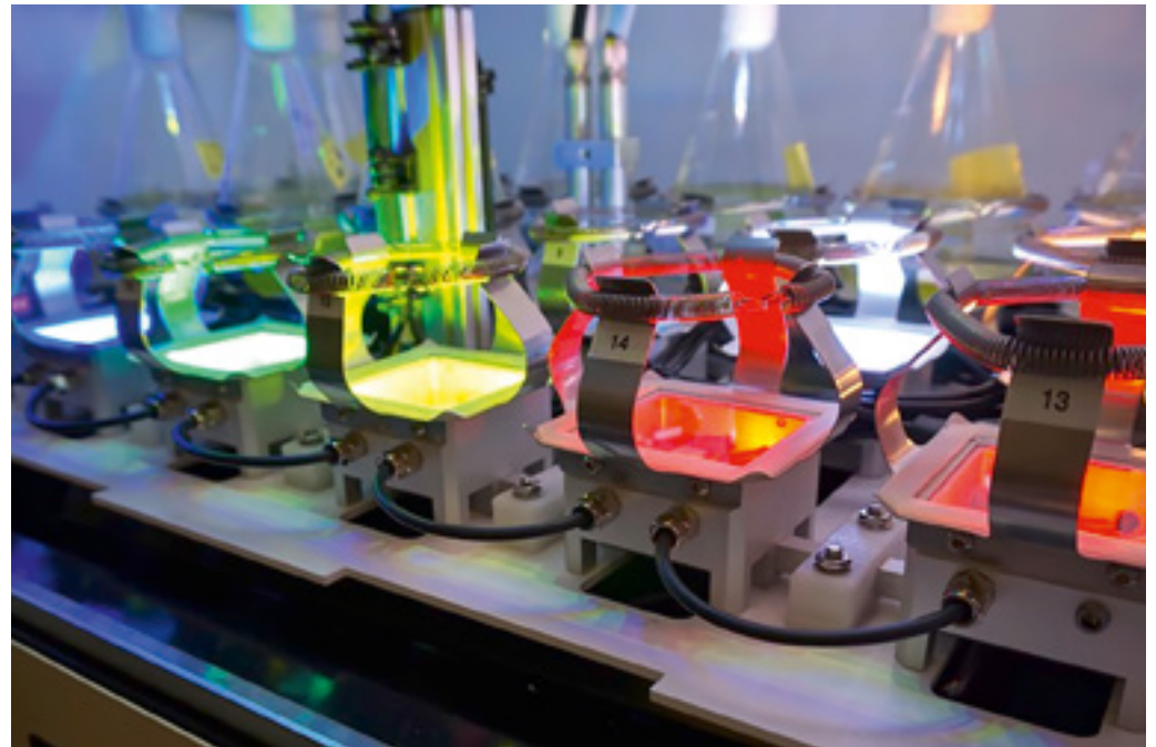
Abb. 4 In dem neuartigen Beleuchtungstablur kann in 18 parallelen Beleuchtungsszenarien mittels Kombination verschiedener LEDs das komplette Sonnenspektrum abgebildet werden.
