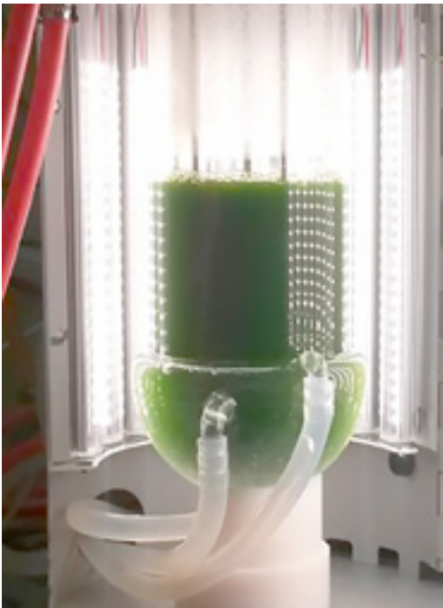
Abb. 3 Im 3,7 l-LED-Photobioreaktor können unter kontrollierten Bedingungen Prozessparameter wie pH-Wert, Temperatur und Beleuchtung untersucht werden.
